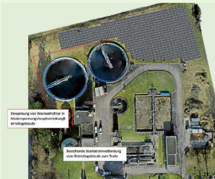
Simulation der Freiflächen-Photovoltaikanlage
