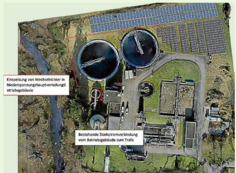
Alternative: Simulation der Freiflächen-Photovoltaikanlage mit Solarcontainer
