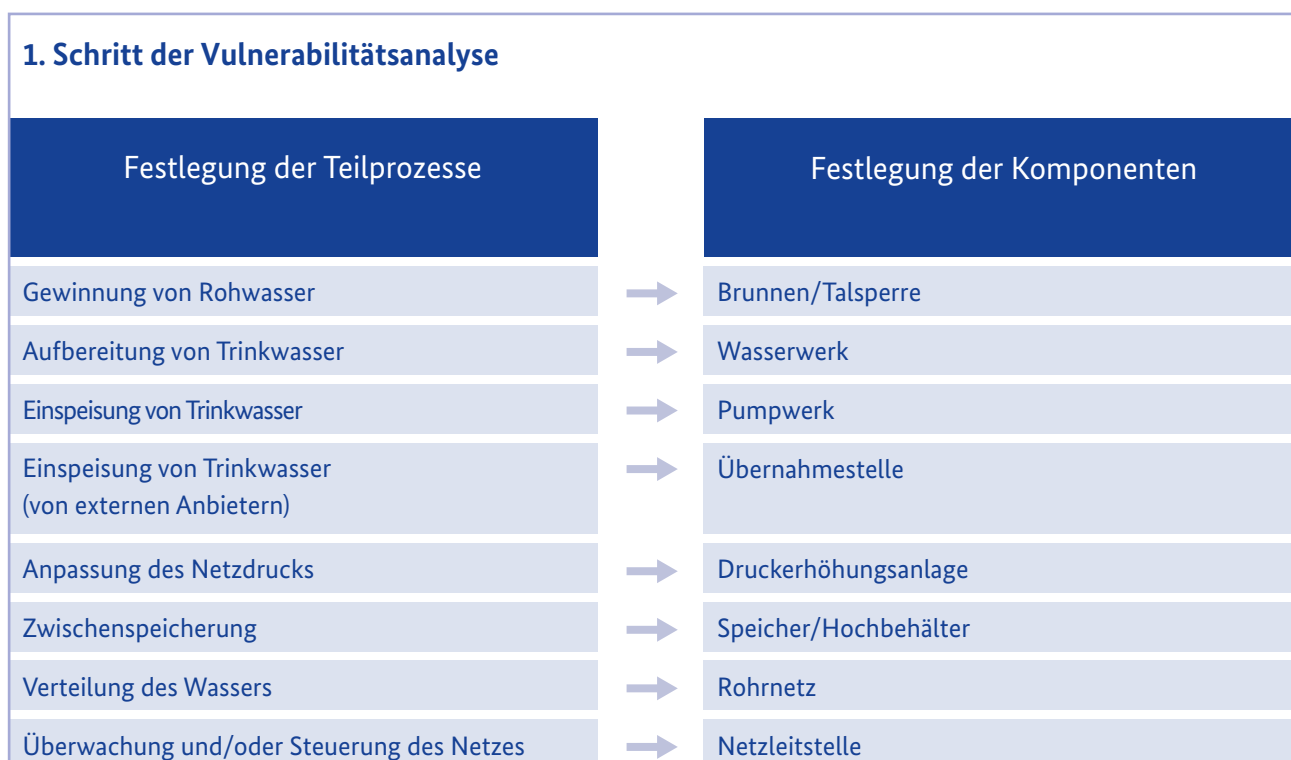
Abb. 14: Exemplarischer erster Schritt der Vulnerabilitätsanalyse – Festlegung von Teilprozessen und Komponenten
